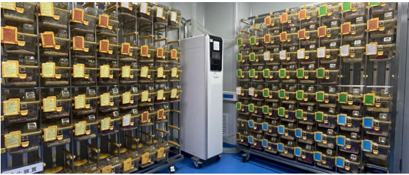
啮齿类饲养间配备 IVC，独立的进排风系统，有效控制交叉污染，确保动物及人员的安全
